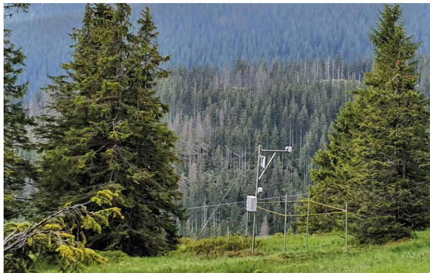
Samostatně stojící sněhoměrné stanice, vlevo Richtrový boudy (1 222 m n. m.) okr. Trutnov, vpravo Jelení studánka (1 238 m n. m.), okr. Bruntál. Stanice měří výšku sněhu, teplotu a vlhkost vzduchu. Kontrolní měření sondou probíhá přibližně dvakrát za sezónu. Foto: J. Jiráček a V. Šustková.
